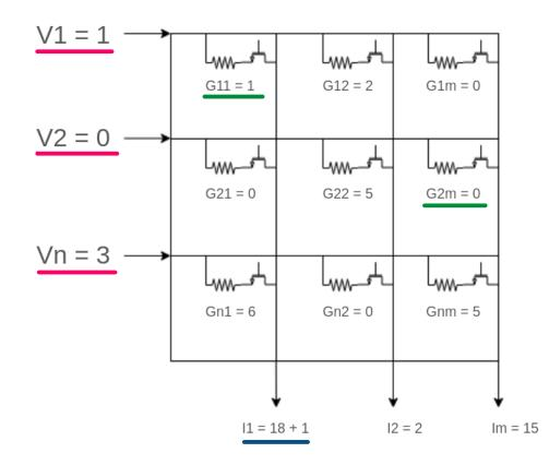
$$\begin{bmatrix} V1 \ V2 \ Vn \end{bmatrix} \cdot \begin{bmatrix} G11 & G12 & G1m \\ G21 & G22 & G2m \\ Gn1 & Gn2 & Gnm \end{bmatrix} = \begin{bmatrix} I1 \\ I2 \\ Im \end{bmatrix}$$
